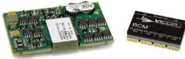
右圖比較Vicor的BCM和一個典型開框1/4磚模組
