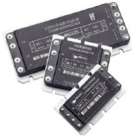
圖 1. 全磚, 半磚及 1/4 磚高密度 DC-DC 傳換器. 體積最少的只有 2.28 \times 1.45 \times 0.5 吋 ( 57.9 \times 36.8 \times 12.7\text{mm} ), 功率達 150W.
