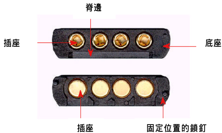
圖3. SurfMate 是可以表面貼裝在電路板上的底座，它提供可連接模块的插頭介面。上方是與模块引腳連接的插座，下方是表面貼裝墊。
