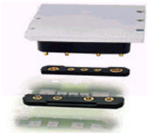
圖 2. 連接系統包括一對插頭底座（圖片前方是輸入端插頭），經標準回流焊接工序，焊好在電路板上後，再把 DC-DC 轉換器（上方）裝上。
