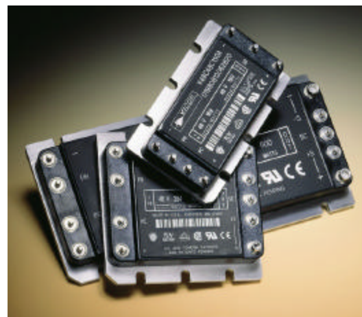
圖1. 有多種尺寸、輸入、輸出電壓功率選擇的 DC-DC 轉換器，滿足多種電源需求。圖中所示是全磚、半磚及1/4 磚DC-DC 轉換器，常用輸入電壓是12、24、28、36、48、50、72、150、270、300 及375Vdc (表1)，只有少數供應商能提供這樣闊的選擇！典型輸出電壓有 1.8、2、2.5、3.3、5、12、15、24、28 及48Vdc (表2)，大部份DC-DC 模塊都可微調輸出電壓，有些模塊的可調範圍是額定值的 -90% 至 +10%。
